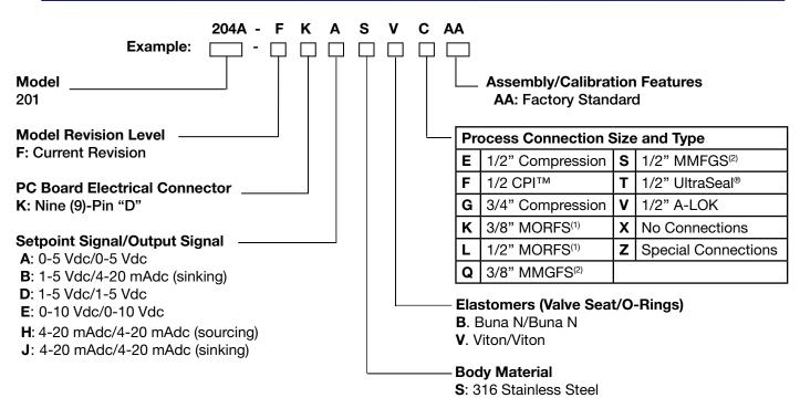
A-LOK<sup>®</sup>, CPI<sup>™</sup>, UltraSeal<sup>™</sup>, VacuSeal<sup>™</sup> - Parker Hannifin Corp. <sup>(1)</sup>MORFS = Male O-Ring Face Seal <sup>(2)</sup>MMGFS = Male Metal Gasket Face Seal
